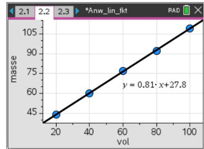
Zum Vergleich werden in der Tabellenkalkulation die zum gegebenen Volumen gehörenden Massen mit dieser Gleichung ermittelt. Es ist zu erkennen, dass sich die Messwerte von denen des mathematischen Modells (also den Funktionswerten der Gleichung  $m(V)$ ) nur wenig unterscheiden.
